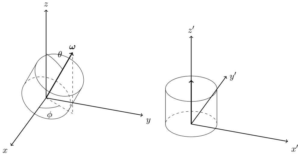
Figura 4: rappresentazione della diagonalizzazione del tensore di inerzia, con  $\omega$  si è indicato il vettore velocità angolare. Nel secondo sistema di riferimento  $(x', y', z')$  il tensore di inerzia risulta diagonalizzato tramite una rotazione degli assi (ruotati in modo da far corrispondere la direzione di  $\omega$  con la direzione di  $z'$ ).
