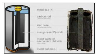
Per quanto riguarda gli *accumulatori irreversibili*, vi è per esempio la pila di Leclanché. Questa pila è a forma di cilindro ed ha un rivestimento di zinco. Al suo interno vi è un elettrodo cilindrico di graffite che non partecipa alle reazioni; esso è ricoperto da una parte di ossido di manganese(II) (MnO<sub>2(s)</sub>) e una di cloruro d'ammonio (NH<sub>4</sub>Cl). La reazione che avviene:
