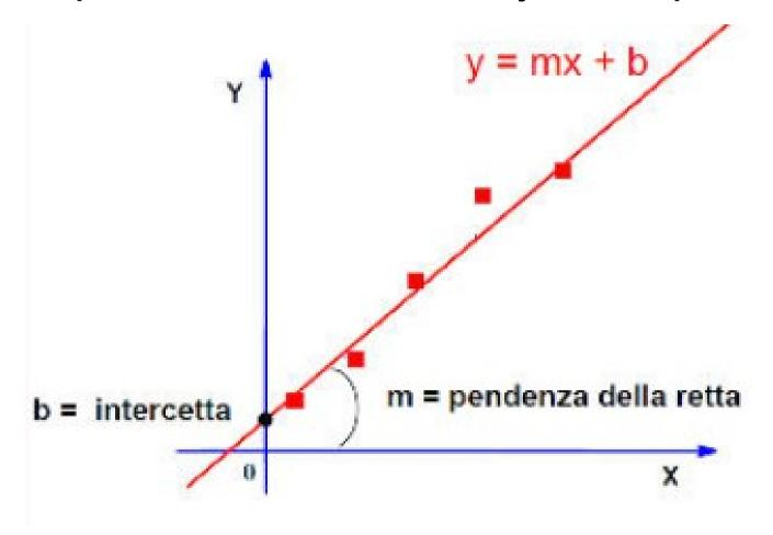
Attraverso la curva di taratura è possibile ricavare valori a partire da un segnale, qualora il coefficiente di correlazione R sia vicino a 1 (un buon coefficiente di correlazione è solitamente superiore a 0,99). Tanto più è vicino a 1 tanto più il valore ricavato sarà affidabile.
