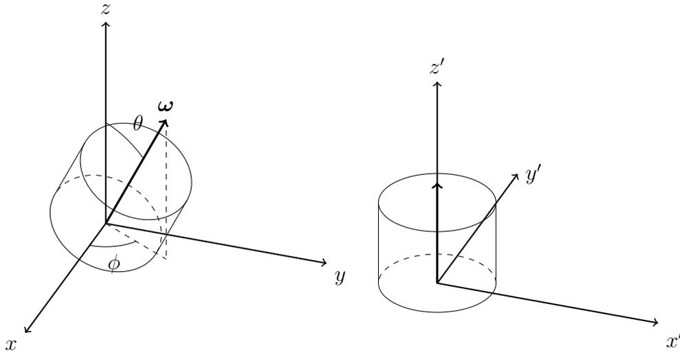
Figura 10.1: rappresentazione della diagonalizzazione del tensore di inerzia, con  $\boldsymbol{\omega}$  si è indicato il vettore velocità angolare. Nel secondo sistema di riferimento  $(x', y', z')$  il tensore di inerzia risulta diagonalizzato tramite una rotazione degli assi (ruotati in modo da far corrispondere la direzione di  $\boldsymbol{\omega}$  con la direzione di  $z'$ ).
